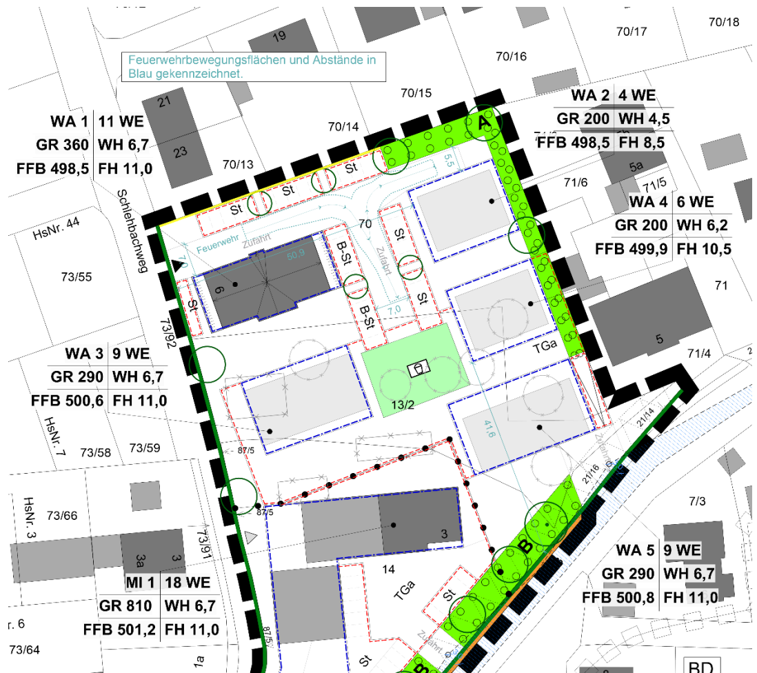
Abb. 21 Feuerwehrrangierflächen innerhalb der geplanten Zufahrten
